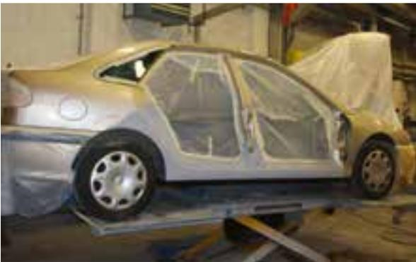
Die Aussen- und Innenteile aus Blech werden fachmännisch gerichtet, ausgebeult und egalisiert. Bei grösseren Schäden wird die defekte Stelle herausgetrennt und das entsprechende Neuteil nach den Herstellerrichtlinien eingepasst und eingeschweisst. Nach der fachmännischen Instandstellung wird das Fahrzeug in die Lackiererei verschoben.
